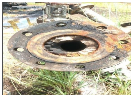
Gambar 2.1 Endapan Scale Pada Pipa Produksi
