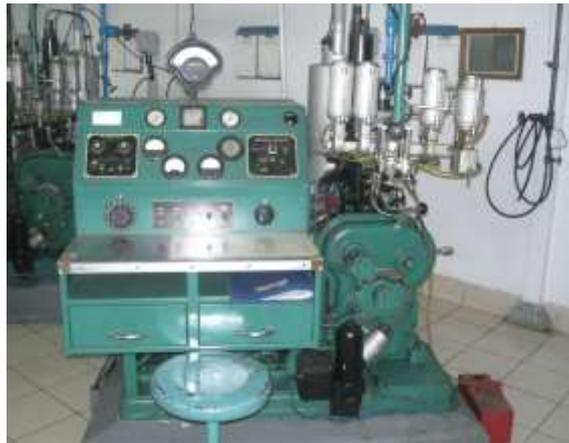
**Gambar 1. Mesin pengujian angka oktana jenis F<sub>1</sub>**
