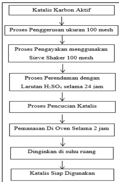
**Gambar 3.2** Blok Diagram Proses Preparasi Karbon Aktif
