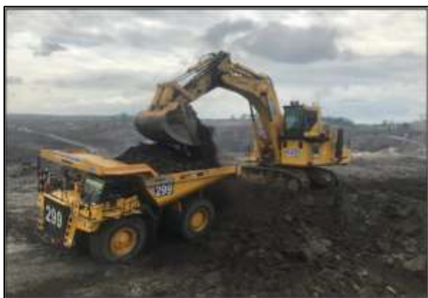
Gambar 2.1 Pemindahan Lapisan Overburden
