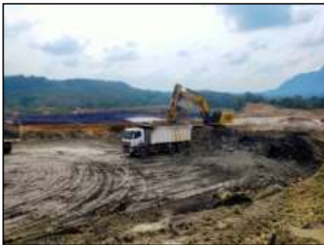
Gambar 4.1 Pola Pemuatan Overburden Fleet EXZ 5005
