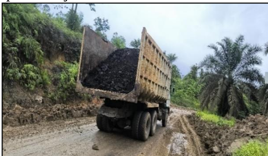
Gambar 4.9 Dump Truck yang Tidak Memiliki Penutup Vessel
