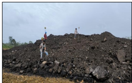
Gambar 4.11 Kegiatan Pengukuran Menggunakan Prisma di Stock ROM
