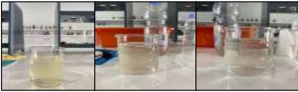
Gambar 3.1 Air Sumur Sebelum dan Sesudah Penyaringan 1 dan Penyaringan 2
